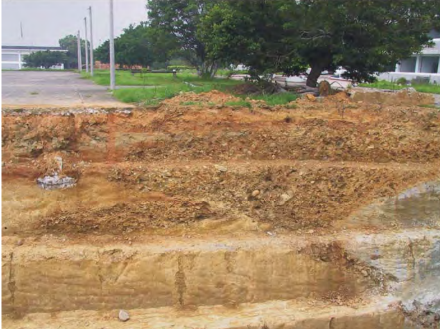
圖 4-4 新城斷層篤行營區的開挖露頭。A：槽溝全景，遠方灰色部分為卓蘭層。B：卓蘭層逆衝至厚層砂岩與紅土礫石層之上，礫石層捲入斷層帶內（陳文山等，2002）。
